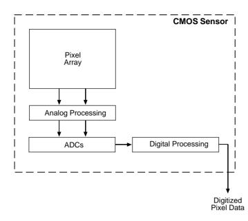
Fig. 33: CMOS Sensor Architecture
